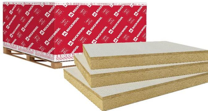
Panel rígido de lana de roca de doble densidad. Cara superior de mayor densidad con gran resistencia a pisadas y un revestimiento de acabado que ayuda a soldar las láminas asfálticas impermeabilizantes.
