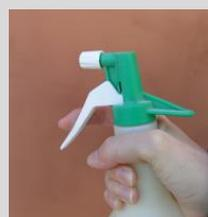
En caso de imperfecciones en las diferentes capas excepto en la de acabado, se recomienda pulverizar localmente con agua cuando el producto haya secado al tacto y alisarlas con el paso de la llana o con una brocha humedecida, cuando el producto haya cogido consistencia, o bien lijarlas cuando el producto haya secado.
